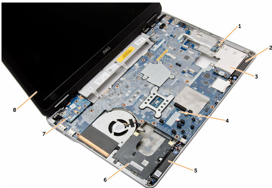
Figura 2. Vista superior — teclado e o conjunto do apoio para as mãos removido
